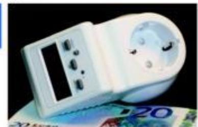
Mit einem Energiemessgerät lässt sich der Stromverbrauch von allen Geräten, die an eine Steckdose angeschlossen werden, messen und somit Stromfresser entlarven.
